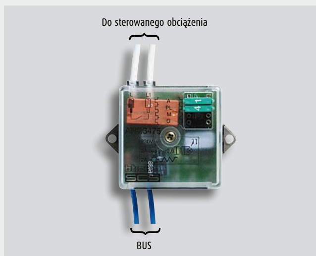
Instalacja aktora do sterowania roletami
