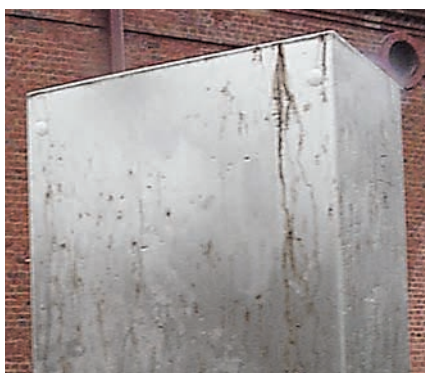
< Stal nierdzewna zardzewiała z powodu skażenia żelazem.
