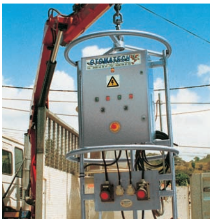
^ Specjalne zabezpieczenie przed uderzeniem dla przenośnej rozdzielni.
