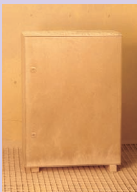
Ochrona przed ciałami stałymi: próba talku zgodna z normą EN 60529.
