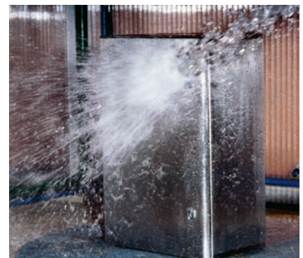
^ Próba zabezpieczenia przed wnikaniem rozbryzgiwanej wody IPX6.
