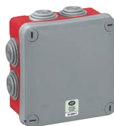
< Puszki rozgałęźne oraz ich podłączenia muszą przejść pozytywnie test palności rozżarzoną drutem żarowym o temperaturze 960°C. Powinny być oznakowane czerwonym kolorem.
