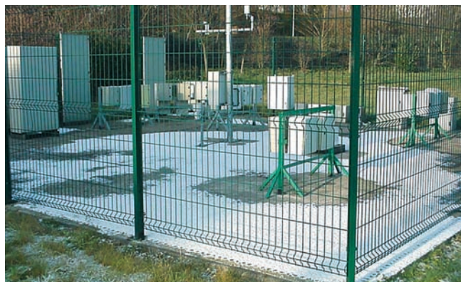
^ Strefa naturalnej degradacji obudów firmy Legrand w stacji meteorologicznej.
