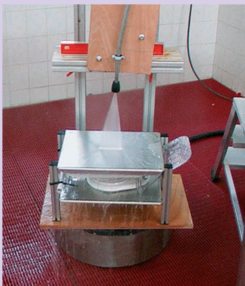
^ Urządzenie do kalibrowania umożliwiające pomiary ciśnienia uderzeniowego według metody NordTest NT Elec023.
