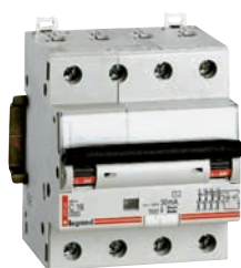
^ Wyłączniki różnicowonadprądowe 4-biegunowe – monoblok, char. C od 10 do 32 A, I_{\Delta n} = 30 i 300 mA, typ AC.
